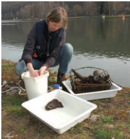
Mitarbeiter der Wasserwirtschaftsämter Bad Kissingen und Aschaffenburg bringen Auswuchskäfige im Main aus. Anhand der Besiedlung mit wirbellosen Kleinlebewesen lassen sich kritische Veränderungen der Wasserqualität erfassen.
